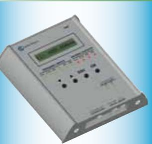
Générateur automatique d'impulsion - système de positionnement absolu qui peut être utilisé pour des manoeuvres HIDRA 2010 et ECON-OIL et qui peut travailler à travers l'un des systèmes suivants:
